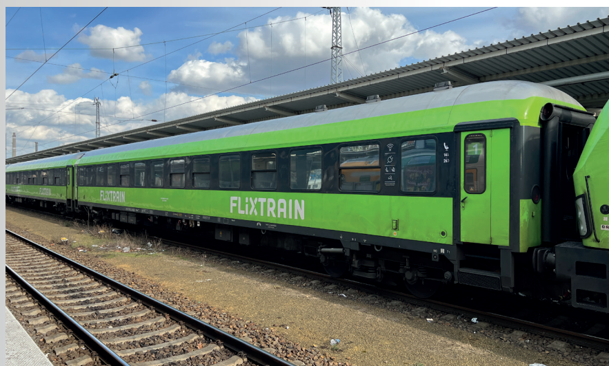
Reisezugwagenset „Flixtrain“, Teil 1, bestehend aus zwei Reisezugwagen Bmmz 264.4 und einem Bmmbz 266.9 Passenger coach set "Flixtrain", part 1 with two passenger coaches Bmmz 264.4 and one Bmmbz 266.9
