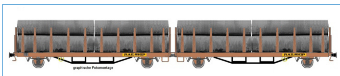
4achsige Flachwagen-Doppelunit Bauart Laas 1 der Fa. Railship eingestellt bei der DR (Epoche IV) rotbraun einfarbig, beladen mit großen Stahlrohren
