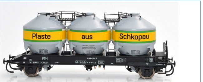
2-achsiger Silowagen Bauart Uc-y der DR Plaste aus Schkopau (Epoche IV) zum Transport von Kunststoffgranulaten, 2. Betriebs-Nr.
