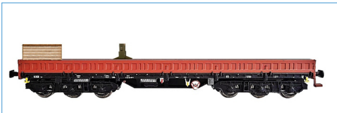
6-achsiger Kranschutzwagen Sas 4850 der DR (Epoche IV) braun-schwarz, mit Stütze für Kranausleger und Holzkiste für Werkzeug
